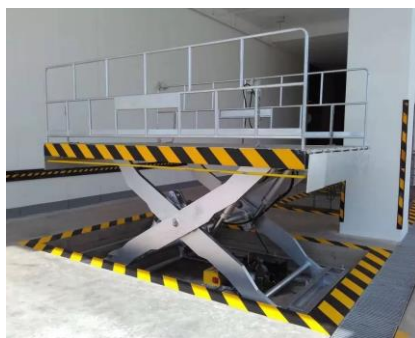
Ψαλιδωτός ανυψωτήρας (Μοχλός, βίδα, οδοντωτή μπάρα)
