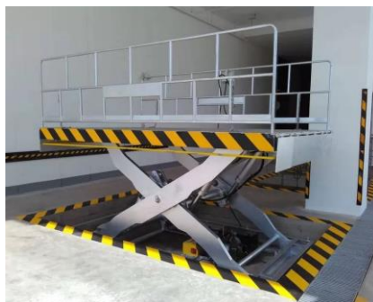
Ψαλιδωτός ανυψωτήρας (Μοχλός, βίδα, οδοντωτή μπάρα)
