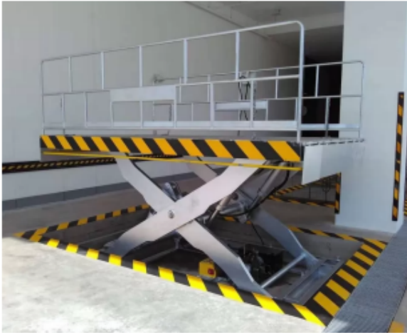
Εικόνα 9 Ψαλιδωτός ανυψωτήρας (Μοχλός, βίδα, οδοντωτή μπάρα)
