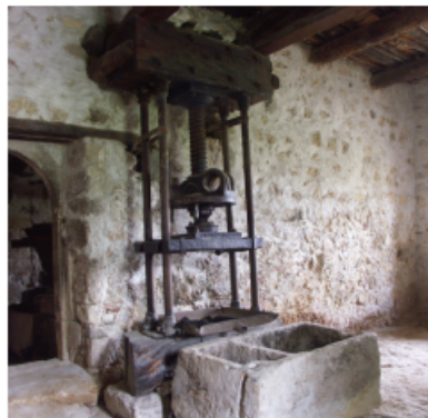
Εικόνα 7 Ελαιοπιεστήριο (Μοχλός, βίδα και άξονες)
