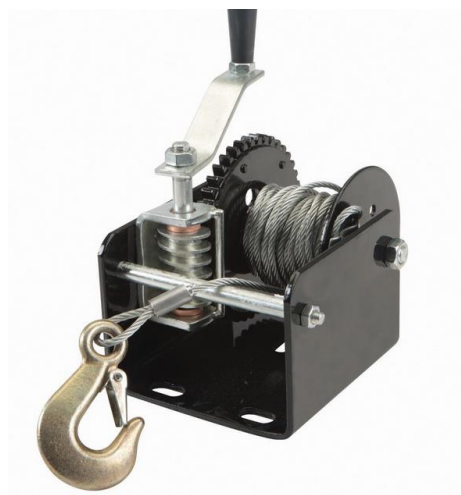
Εικόνα 10 Χειροκίνητο βίντσι με συρματόσχοινο (Γρανάζια, κασάνια, άξονες, βίδες και μοχλός)
