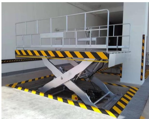
Εικόνα 9 Ψαλιδωτός ανυψωτήρας (Μοχλός, βίδα, οδοντωτή μπάρα)
